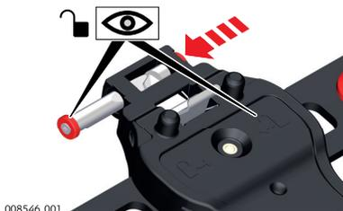
6. Разместите CS-контроллер над креплением и опустите нижнюю часть CS-контроллера на крепёжную пластину.
