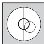
Прежде чем приступать к определению инструментальных ошибок тахеометра, инструмент должен быть отnivelирован с использованием электронного уровня.
