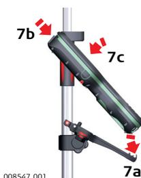
8. После установки CS-контроллера на крепление убедитесь в том, что фиксатор находится в закрытом положении. Для закрытия фиксатора сдвиньте её вправо.
