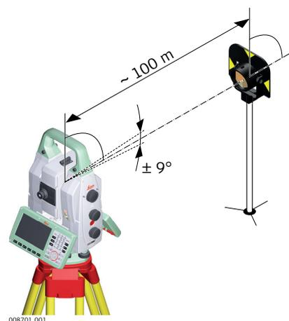
6. **Измерить**, для измерения и перехода на следующий экран. Если установлен флажок **Калибровка коаксиальной камеры**, то точно наведите камеру на этот же отражатель, используя видеоискатель и цифровое перекрестие на экране. **Измерить**, для измерения и перехода на следующий экран.
