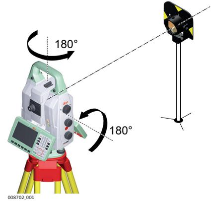
☞ При обоих кругах точное наведение следует выполнять вручную.
